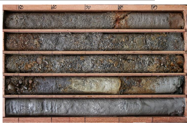
【写真右:ダブルコアチューブを使用した砂礫～シルス地盤コア(平成 29(2017)年)】
