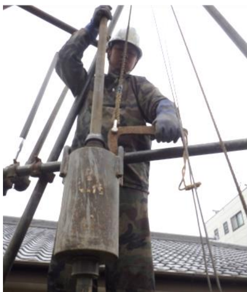
【写真左:“手動落下(トンビ)法”による標準貫入試験(JIS 改正前)】
