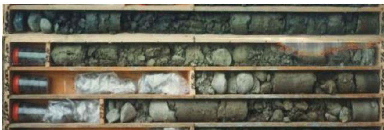
【写真:シングルコアチューブを使用した砂礫地盤コア(平成元(1989)年)ごろ】
