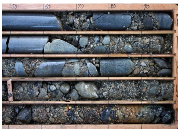
【写真左:ダブルコアチューブを使用した砂礫地盤コア(平成 29(2017)年)】
